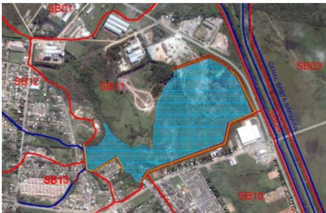
Figura 39: Proposição 1 - Reservatório na cota de coroamento 6,0 m.
