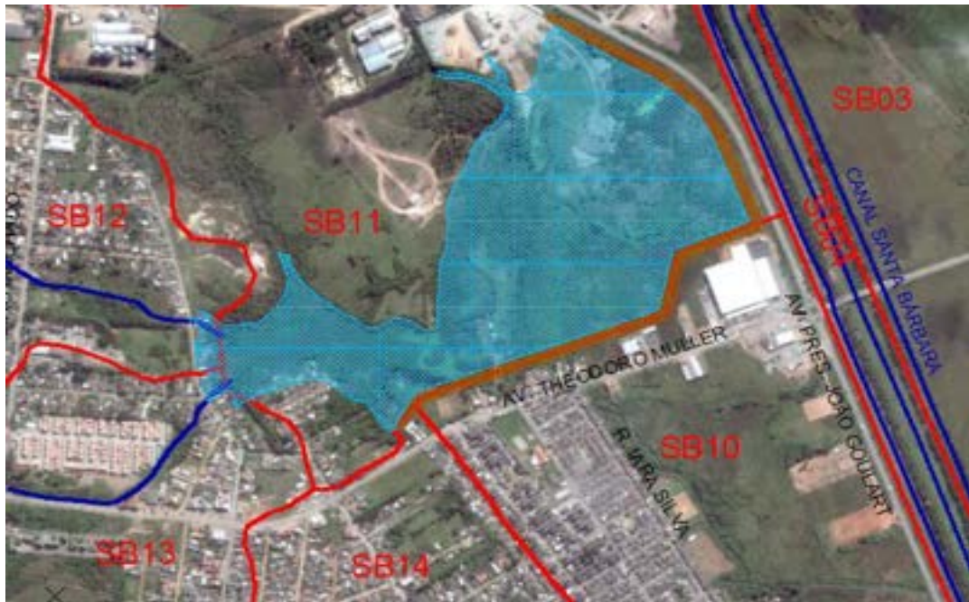
Figura 40: Proposição 2 - Reservatório na cota de coroamento 5,0 m.
