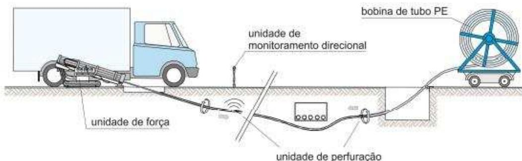
Figura 1 - Esquema de Operação (HDD). Fonte: ABPE.
